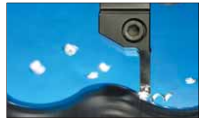
MRGN тип: Использование полной длины окружности
