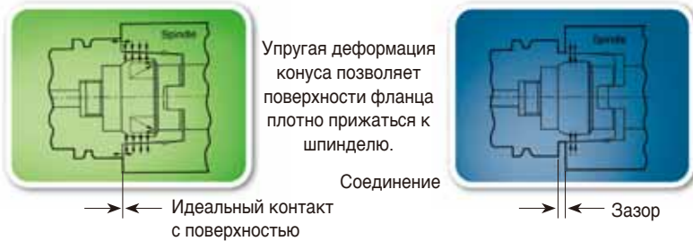
Хвостовик HSK - Идеальная система посадки по 2-м поверхностям
