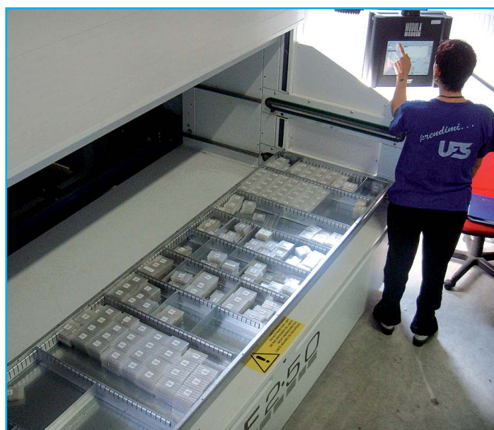
Gestione prodotti finiti con magazzino automatico verticale Automatic load system for taps steels'storage Gestion des produits finis avec entrepôt vertical automatique
