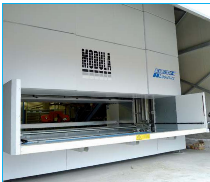
Gestione acciai con magazzino automatico verticale Automatic load system for steels'storage Gestion d'un entrepôt vertical automatique pour l'acier
