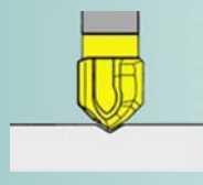
Центровка отверстий/ Снятие фасок
