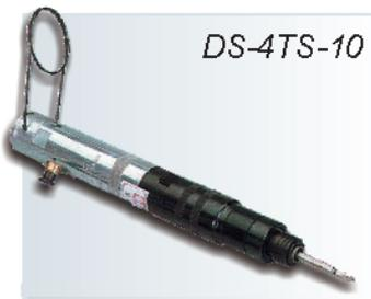
Вращение вставки начинается при осевом нажатии. Постоянный вращающий момент обеспечивает закручивание с заданным силовым параметром. Запорно-выпускная муфта перекрывает воздухоприемник при достижении заданного момента затяжки.
