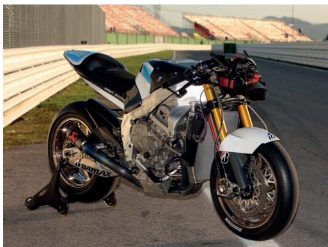
Мотоцикл Suter-BMW имеет двигатель мощностью 230 л.с. и разгоняется до 200 км/ч за 5 секунд
